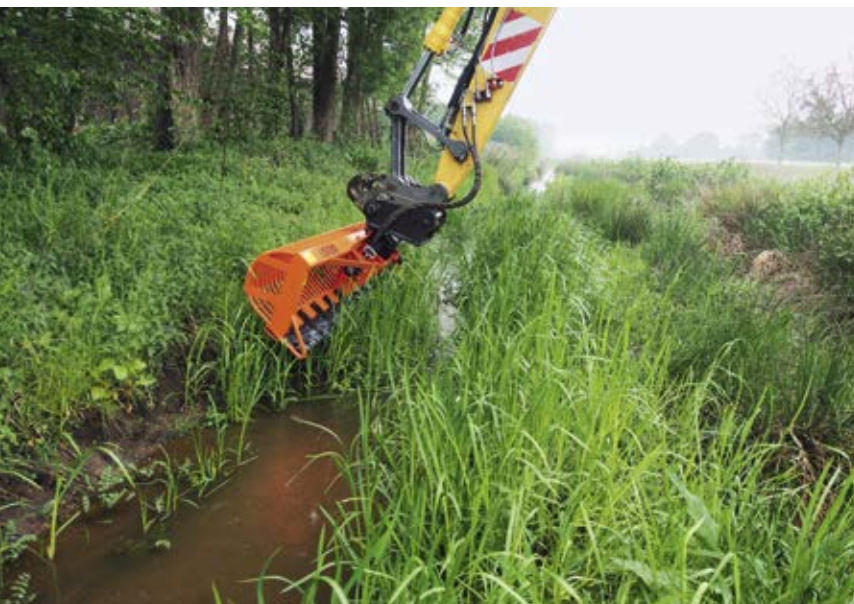
Abb. 2: Der Mähkorb als wichtigstes Arbeitsinstrument kann auch behutsam bis filigran eingesetzt werden, so dass eine naturverträgliche Unterhaltung möglich ist. Links: Belassen eines schmalen Saumes; rechts: Krautung des kompletten Profils (TSCHÖPE 2010–2012)
